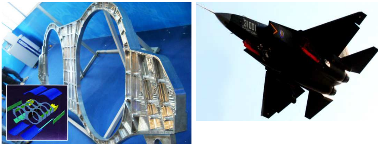
Illustration 20 : le plus grand composant 3D imprimé d'avion de chasse en titane par Laser Direct Manufacturing 52 .
