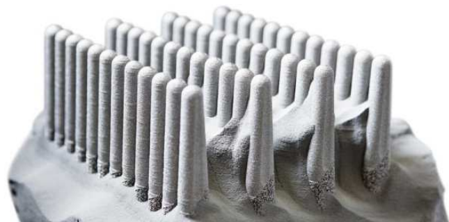
Illustration 4 : objet conçu par DMLS.
